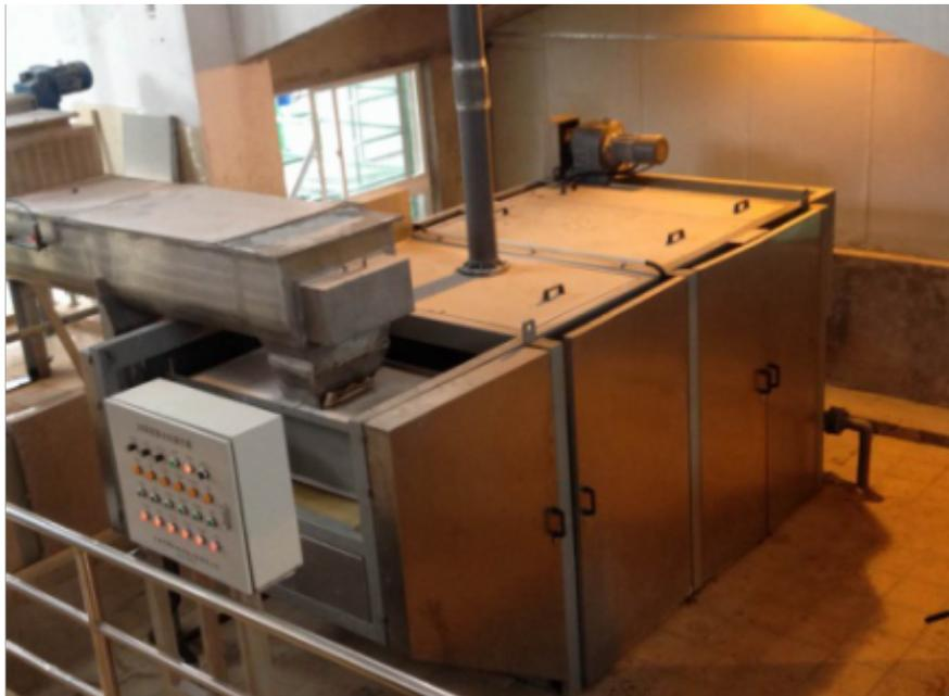
污泥深度脱水的技术和工艺：污泥的深度脱水是指通过对含水率较高的污泥进行化学调质改性处理后，再高压压榨脱水至含水率60%以下，不仅在数量上减少50%以上，更重要的是使污泥后续处置途径更为普遍。深度脱水后的污泥具有一定的热值，可作为电厂低品位的燃料和水泥生产过程中的熟料，实现稳定、无害化处置和资源化利用。即使进行填埋，也能大幅减少土地占用和环境污染。污泥深度脱水技术在国外起源较早，随着污泥处理处置领域技术进步和业内人士认识的提高，近几年在国内逐步得到重视并有一定范围的应用。主要表现在各类科研机构在污泥调质处理技术上不断推陈出新，以及高压压滤脱水技术及装备快速发展。可以说，虽然污泥深度脱水只是污泥处理处置的一个环节，目前的工艺技术尚未完全成熟，但业界对污泥处置技术的认识正在逐步向深度脱水方向靠拢。内蒙古化工污泥深度脱水方案专注精通是上海中耀环保实业有限公司的特点，欢迎广大新老客户来函来电。
